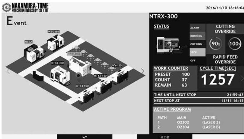
また、「中村留IoT」は機械のモーターやセンサー等から取得したデータをサーバ上に蓄積しているため、蓄積したデータを予防保全に生かすことができます。例えば、主軸やサーボ軸の温度の履歴を確認することができ、故障の予兆をいち早く発見し故障を未然に防ぐことができます。
